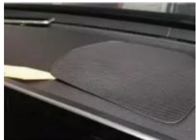
12. Hebeln Sie die originale mittlere Lautsprecherabdeckung
