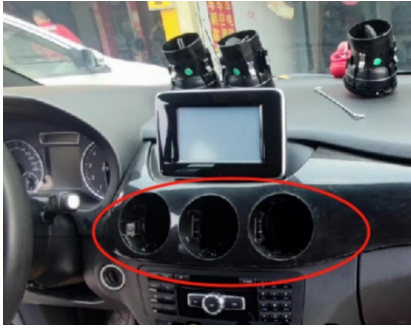
1. Entfernen Sie zunächst den Luftauslass.
