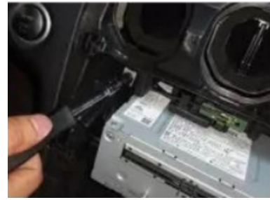
18. Entfernen Sie die Befestigungsschrauben.
