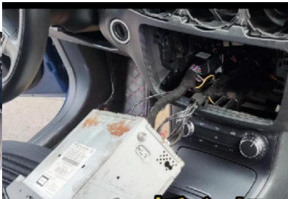
5. Entfernen Sie das Hauptgerät
