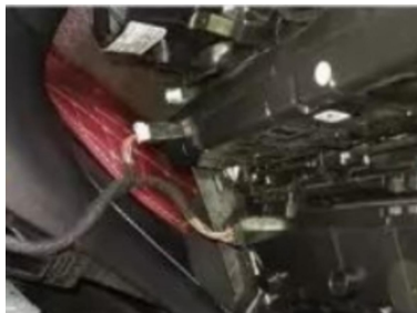
11. Trennen Sie den originalen Fahrzeugstecker.
