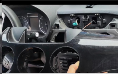
3. Entfernen Sie die Verkleidung.
