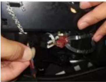
10. Trennen Sie den originalen Fahrzeugstecker auf
