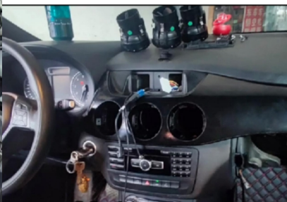
8. Einen neuen Kabelbaum einbauen
