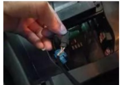
9. Trennen Sie den originalen Fahrzeugstecker.
