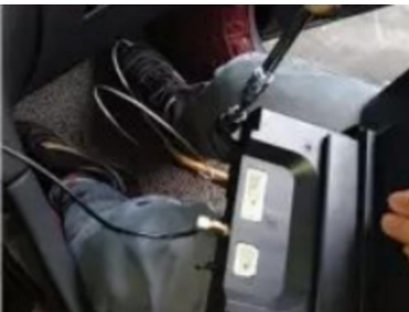
25. Entfernen von zwei Schrauben vom Original-Fahrzeugbildschirm und Einbau der Anzeigeeinheit unseres Unternehmens
