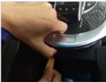
4. Entfernen Sie die originale silberne Verkleidung aus dem Armlehnenfach der Mittelkonsole. die ursprüngliche Mittelkonsole leicht an.
